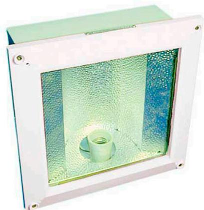
Для общего освещения производственных, коммерческих (выставочных и торговых комплексов), сельскохозяйственных, складских, вспомогательных и других помещений, в т.ч. для наружной установки под навесом, взрывоопасных зон класса 22 и пожароопасных зон классов П-1, П-П. Температура окружающей среды при эксплуатации от -40 С до +40 С (У2), от -60 С до +40 С (ХЛ2).
